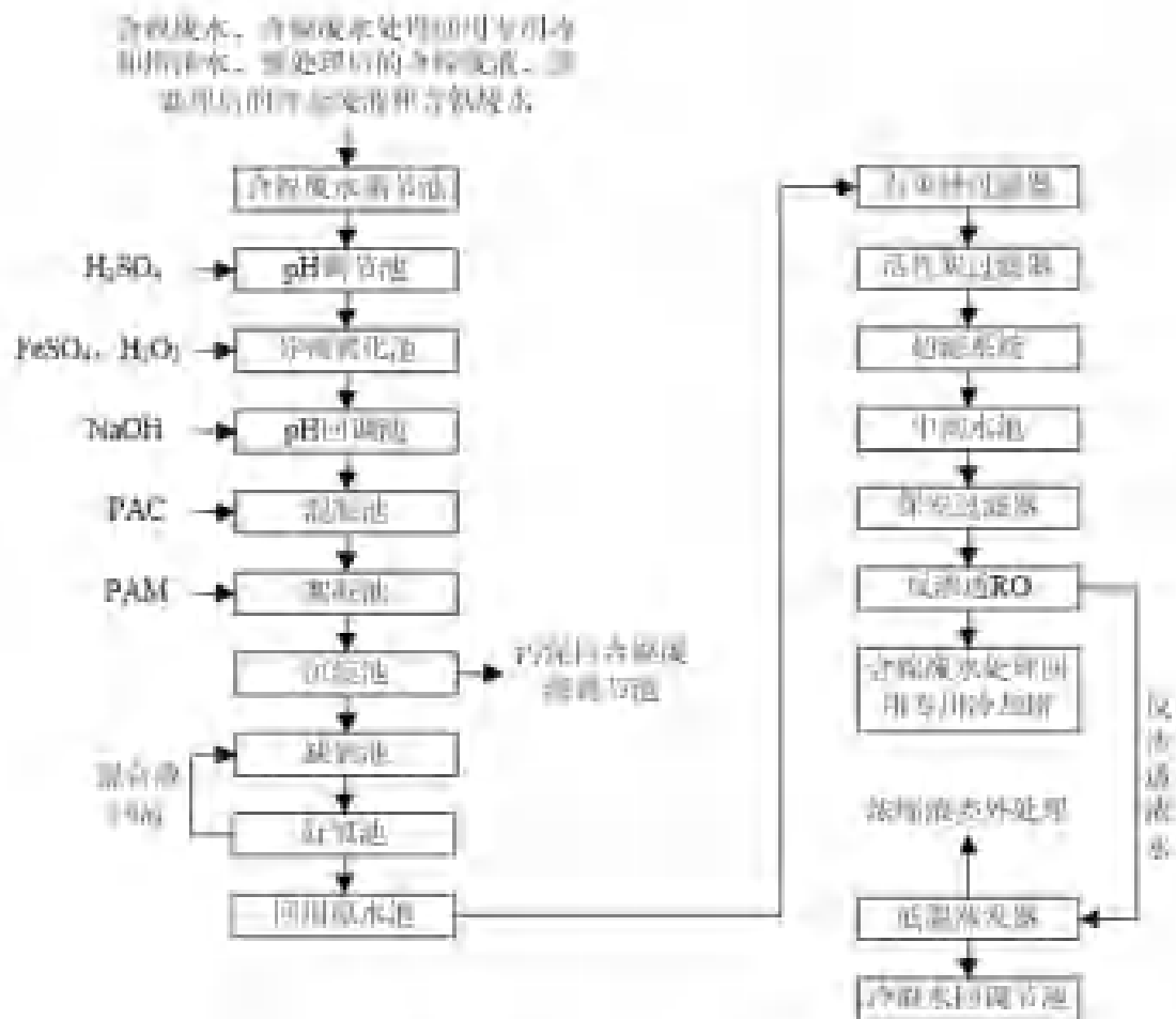
图 9.5-6 含镍废水处理系统处理流程图
