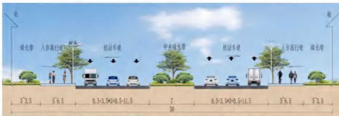
图 2-12 道路典型横断面设计图 (终点主线下穿段)
