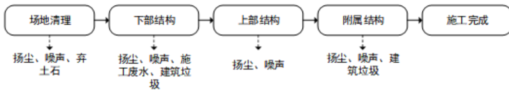
图 2-35 桥梁工程施工工艺及产污环节图
