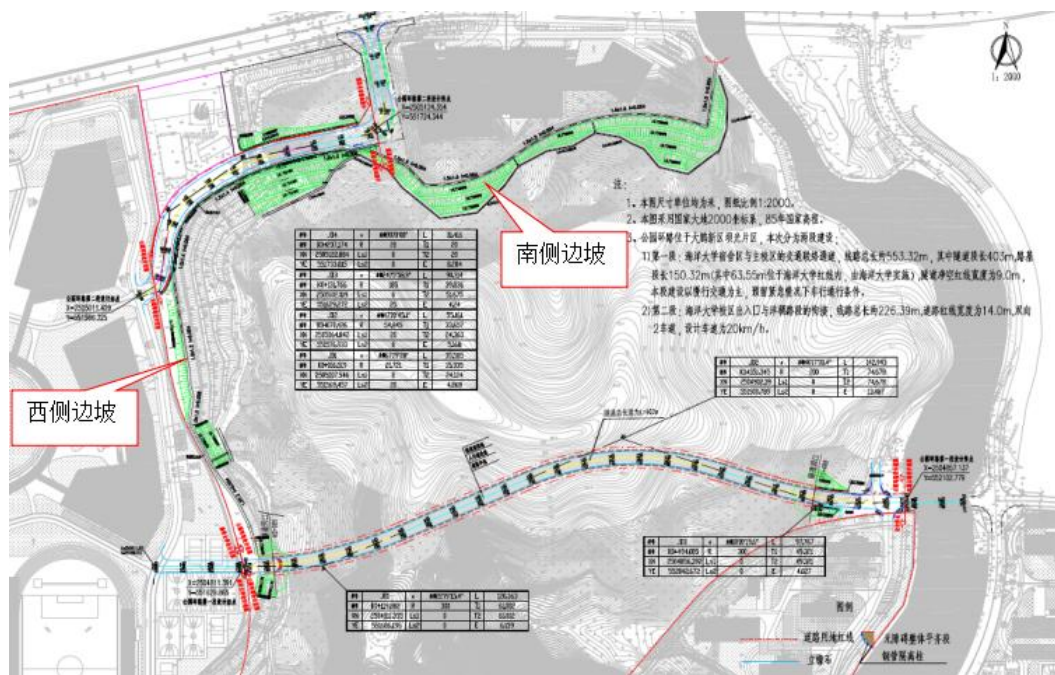
图 2-9 公园环路边坡平面图
