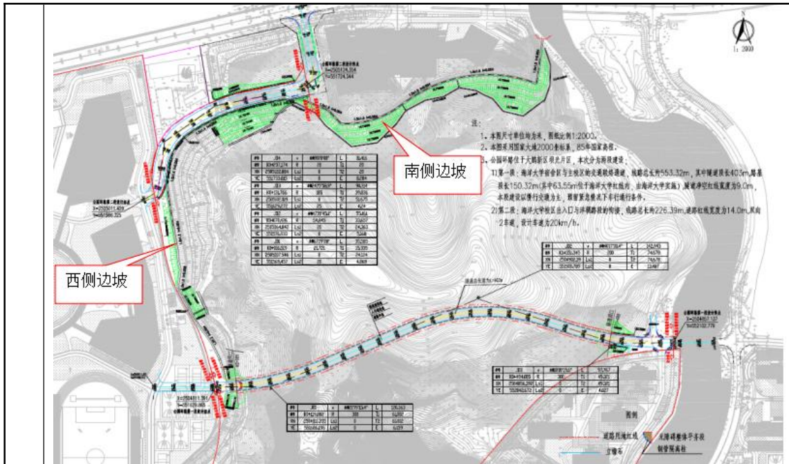
图 2-9 公园环路边坡平面图
