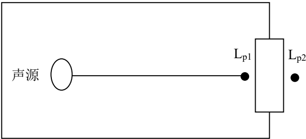
图 4-2 室内声源等效为室外声源图例
