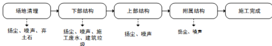
图 2-17 桥梁工程施工工艺及产污环节图
