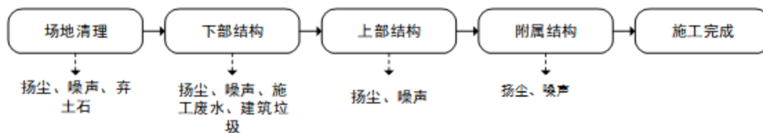
图 2-17 桥梁工程施工工艺及产污环节图
