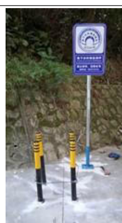
地下水监测井
