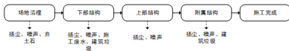
图 2-19 桥梁工程施工工艺及产污环节图
