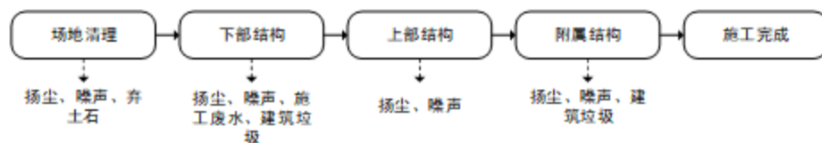
图 2-19 桥梁工程施工工艺及产污环节图
