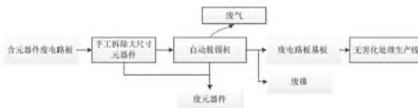
图 2-5 现有项目脱锡处理生产线工艺流程及产污环节图
