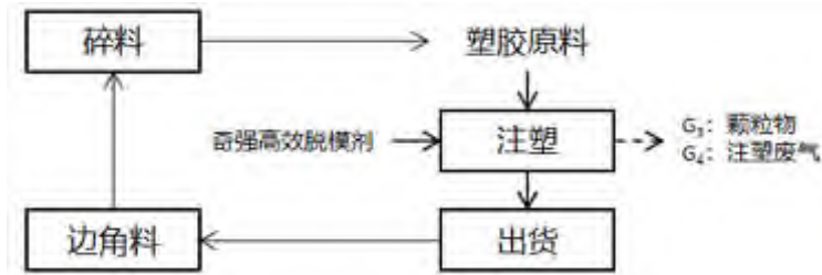
图 2-6 改扩建后项目塑料配件生产工艺流程图
