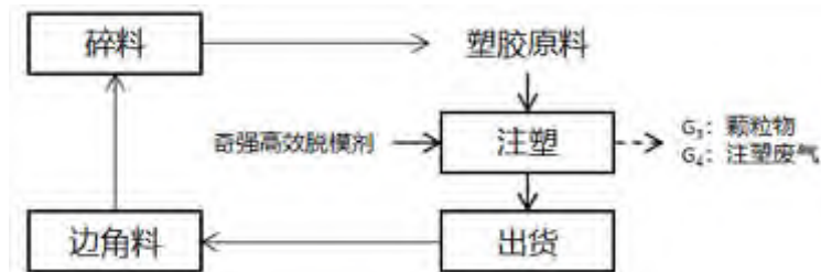
图 2-4 现有项目塑料配件生产工艺流程图
