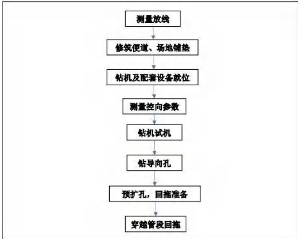
图 2.4-4 定向钻施工工艺流程图
