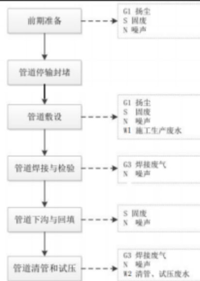
图 2-2 施工期工艺流程及产污环节
