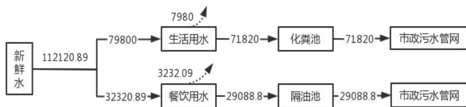
图 2-1 项目水平衡图（单位：m 3 /a）
