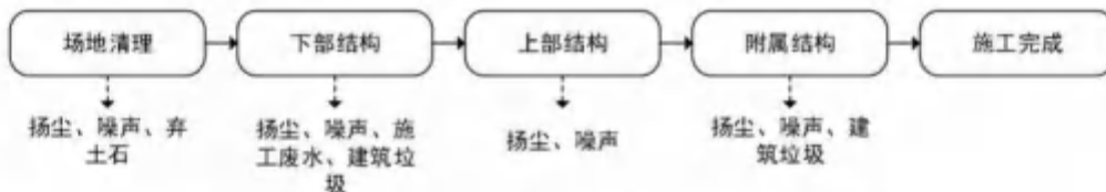
图 2-15 桥梁工程施工工艺及产污环节图
