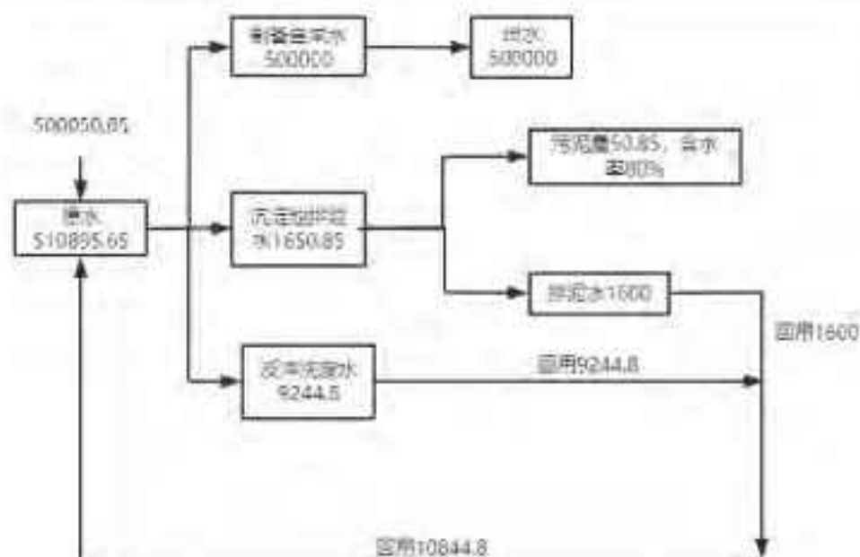
图 2-2 本项目建成后朱坳水厂水平衡图（近期）（m³/d）
