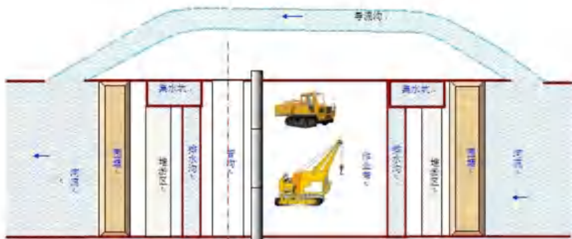
图 4.1-9 围堰导流开挖穿越河流
