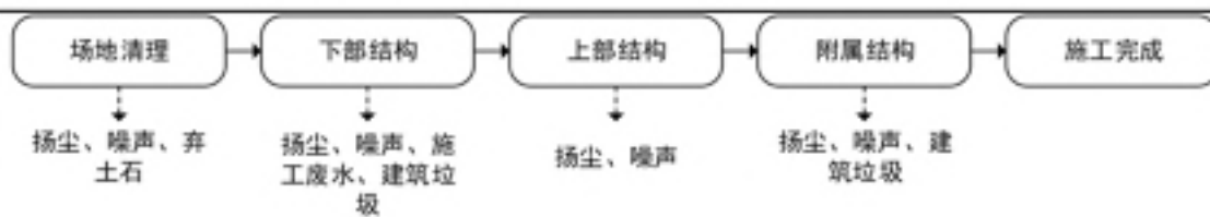
图 2-18 桥梁工程施工工艺及产污环节图
