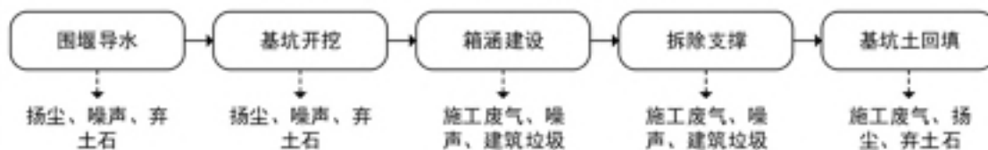
图 2-18 桥梁工程施工工艺及产污环节图
