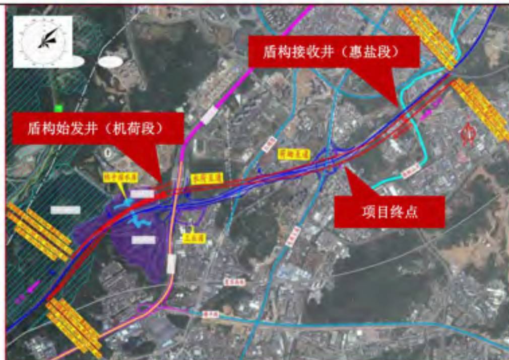
图 2-9 荷坳隧道（双洞盾构方案）平面线位图
