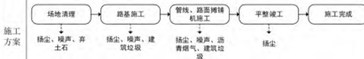
图 2-17 道路施工工艺及产污环节图
