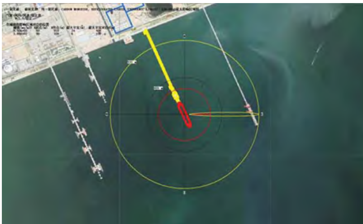
图 7.3-49 丙烷管道（DN450）发生火灾、爆炸引发伴生/次生污染物 CO 排放影响范围图—最不利气象条件
