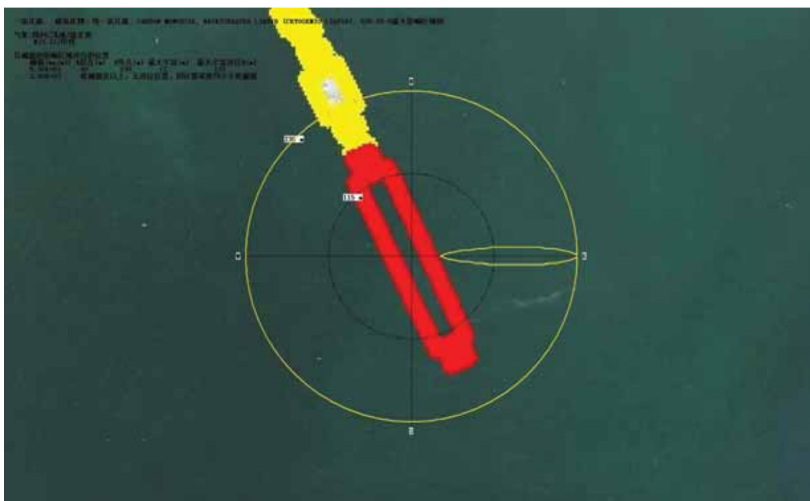
图 7.3-51 丙烷管道（DN450）发生火灾、爆炸引发伴生/次生污染物 CO 排放影响范围图—最常见气象条件
