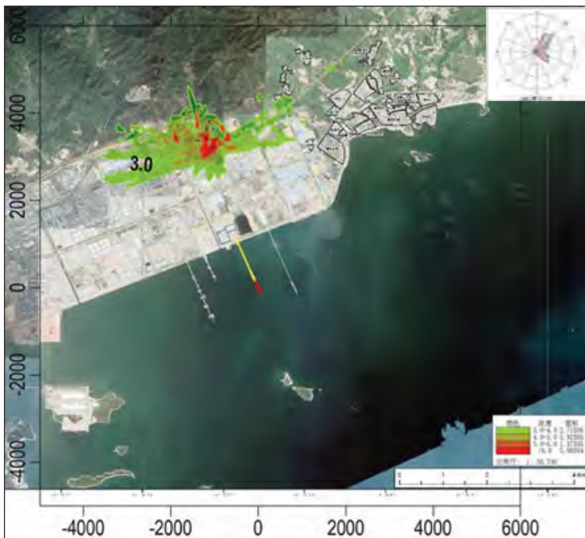
图 8.2-33 1#+2#+3#+7#+4#+8#装卸点装卸时氨气叠加现状浓度后 1 小时平均质量浓度分布图( \mu\text{g}/\text{m}^3 )
