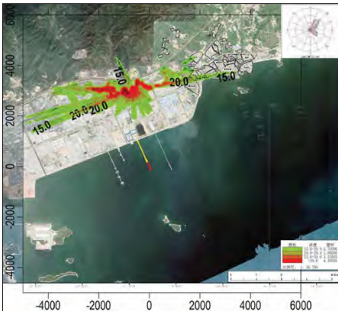
图 8.2-31 1#+2#+3#+7#+4#+8#装卸点装卸时丙酮叠加现状浓度后 1 小时平均质量浓度分布图( \mu\text{g}/\text{m}^3 )
