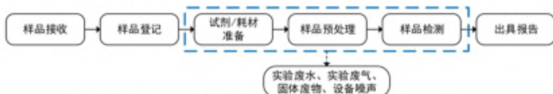
图 2-2 仿制药一致性评价、药用辅料检测、生物制品检测工艺流程图
