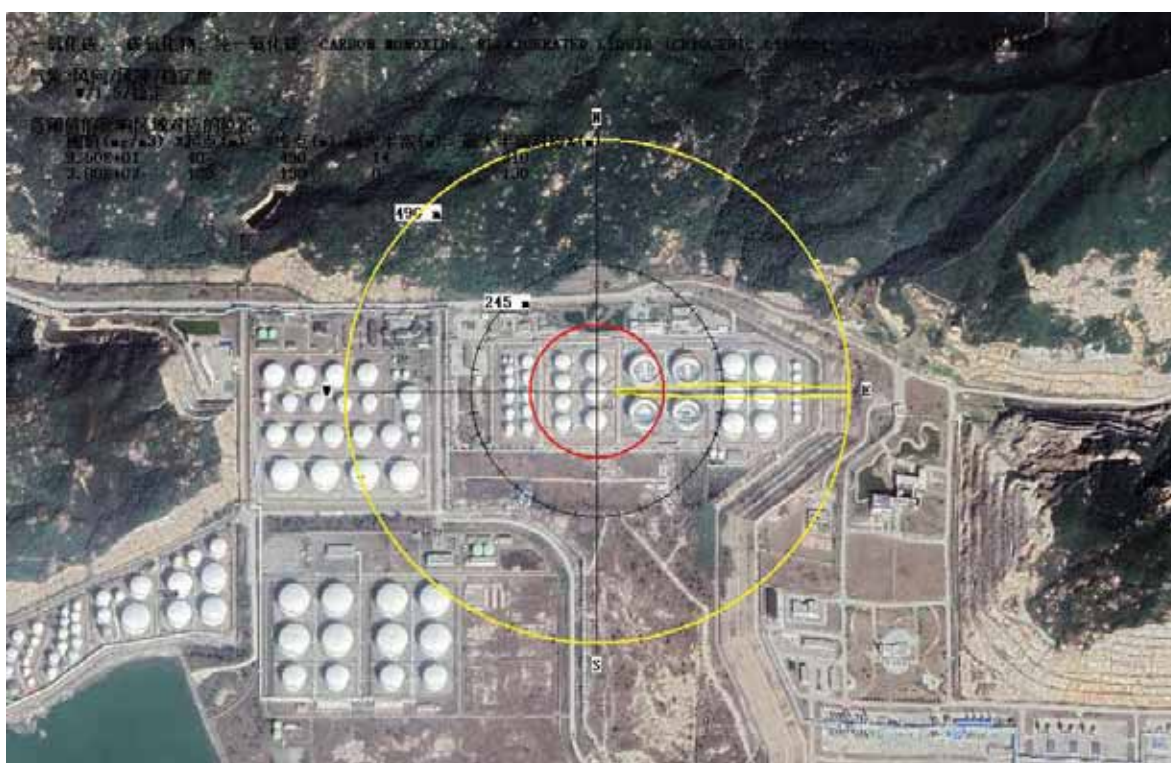
图 2.5-3 T1206 储罐发生 10mm 孔径泄漏事故伴生/次生一氧化碳最大影响区域图
