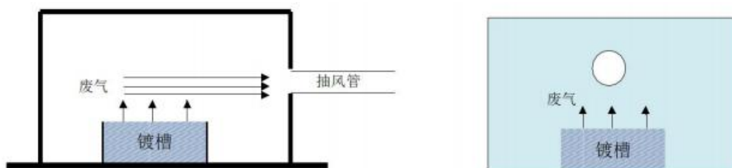
图 3.2-14 电镀生产线排风设计示意图
