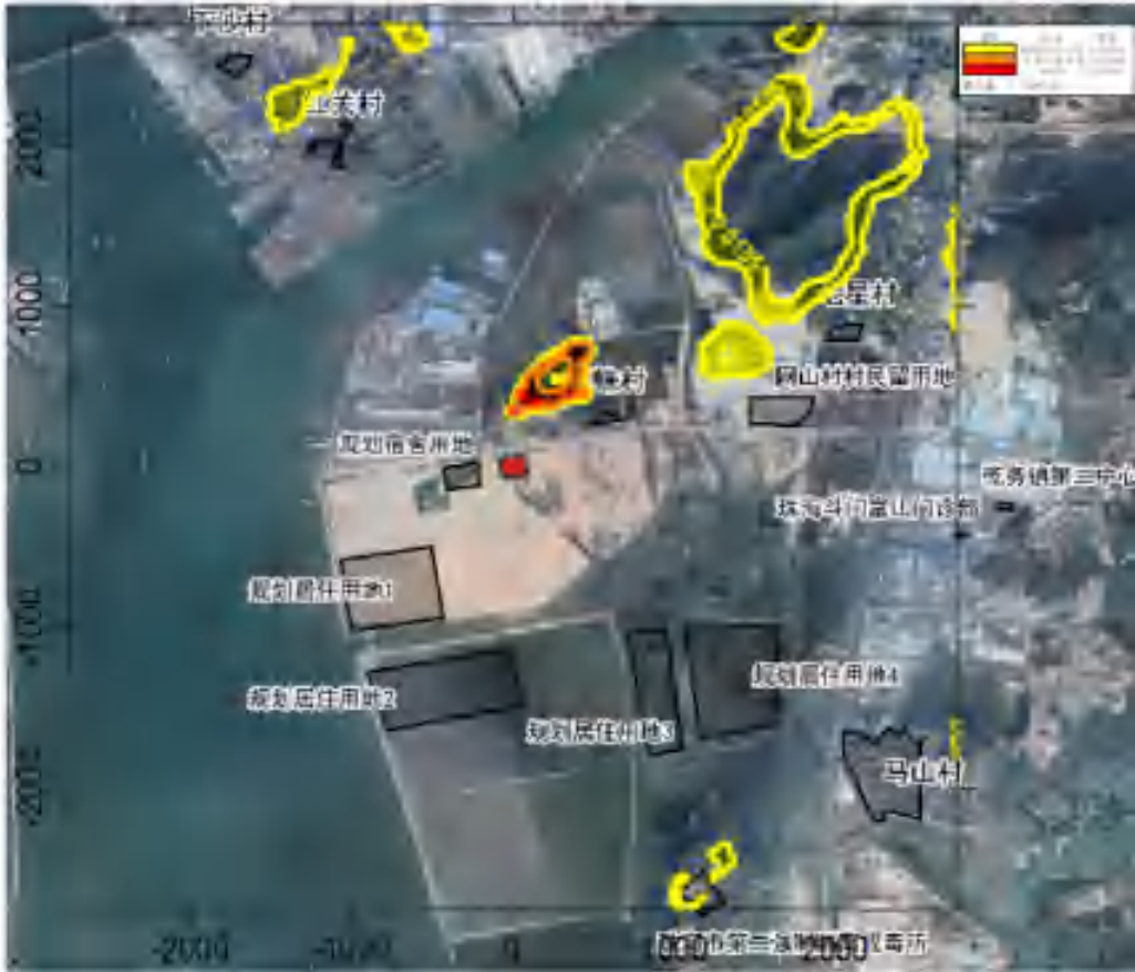
图 2.2-13a 氯叠加现状浓度后小时平均质量浓度分布图( \text{mg}/\text{m}^3 )
