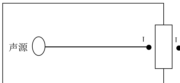
图2.3-1 室内声源等效为室外声源图例
