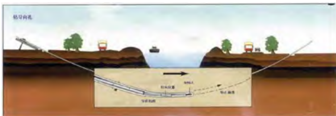
图 4.1-4 钻导向孔示意
