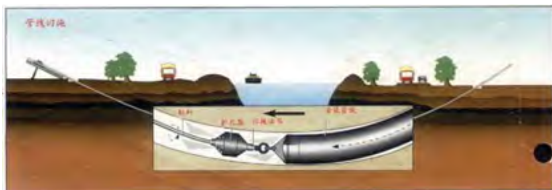
图 4.1-6 管线回拖示意
