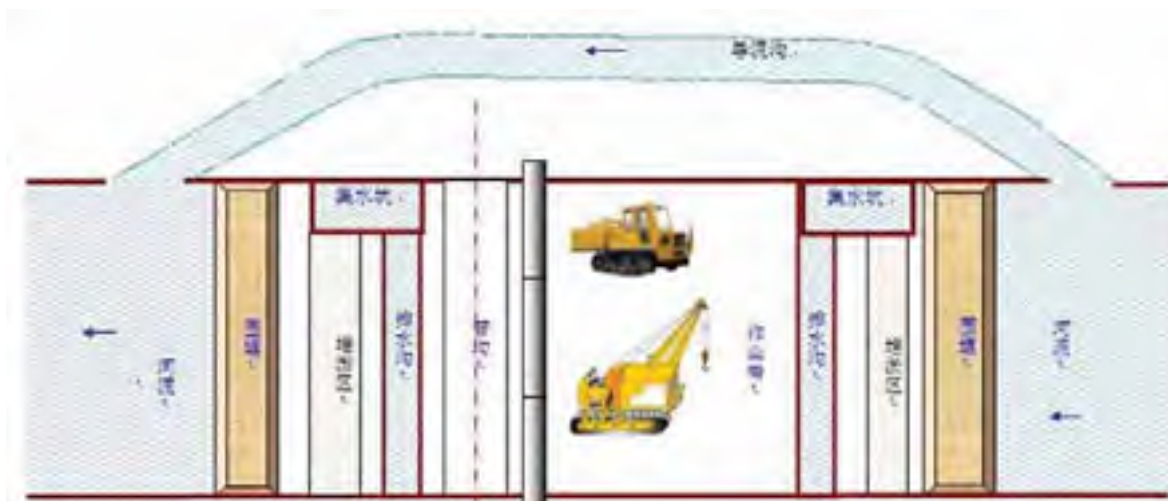
图 4.1-9 围堰导流开挖穿越河流
