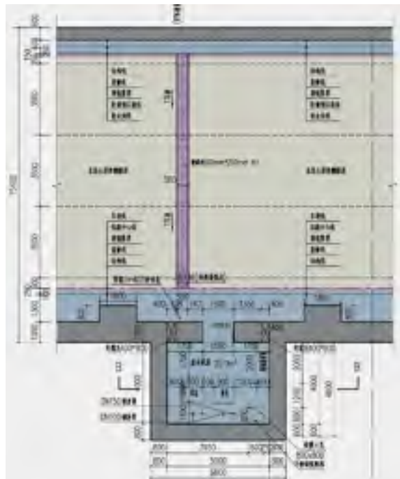
图 1-28 西侧隧道废水泵房平面图
