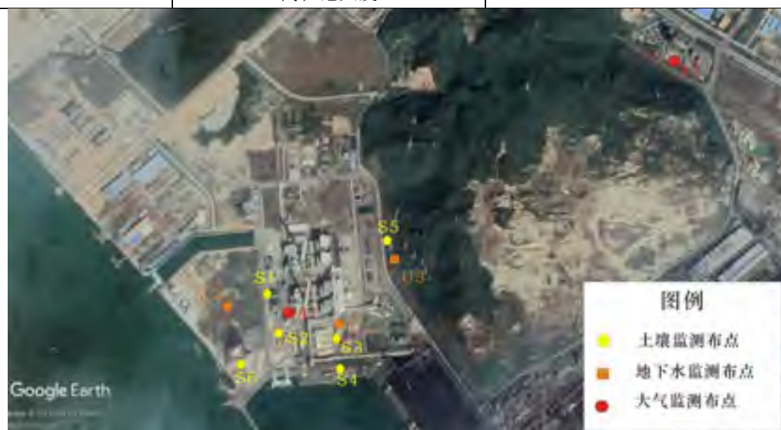
图 5.4-1 空气、土壤、地下水水位监测布点图
