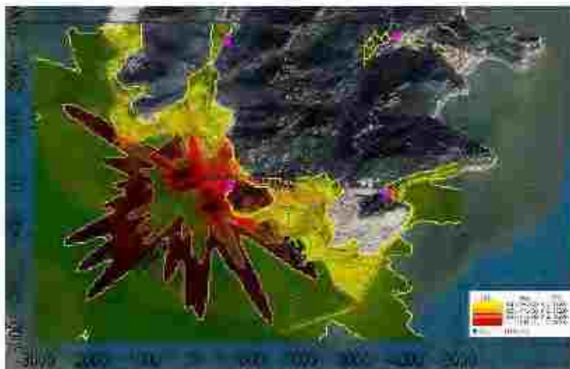
图 8.2-25 1#+3#泊位装卸时甲醇叠加现状浓度后 1 小时平均质量浓度分布图( \text{mg}/\text{m}^3 )
