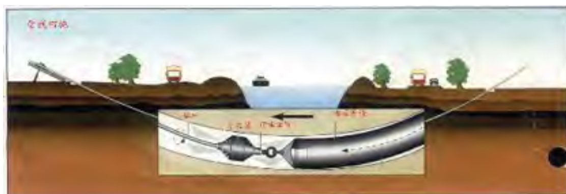
图 4.1-6 管线回拖示意
