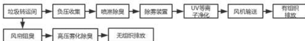
图 1-1 恶臭气体处理工艺流程
