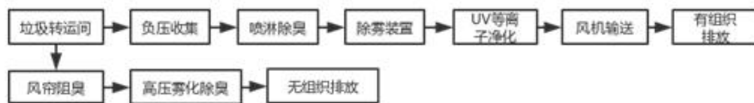
图 8-1 臭气处理工艺流程
