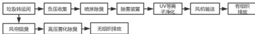
图 1-1 恶臭气体处理工艺流程
