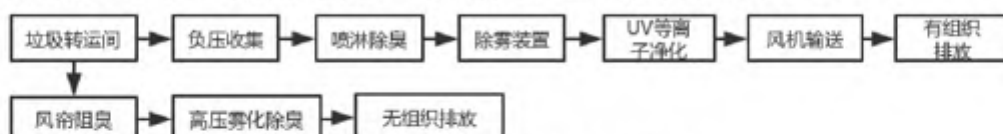
图 8-1 臭气处理工艺流程
