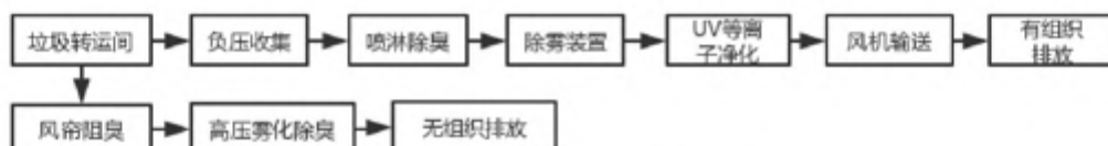
图 1-1 恶臭气体处理工艺流程
