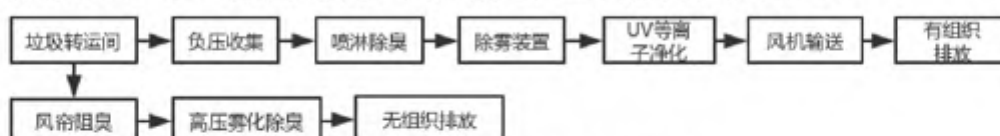
图 8-1 臭气处理工艺流程
