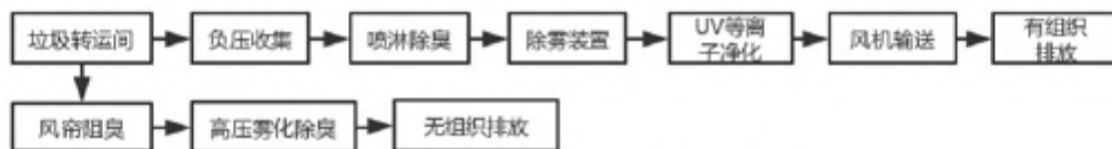
图 1-1 恶臭气体处理工艺流程
