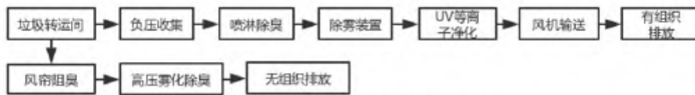
图 1-1 恶臭气体处理工艺流程
