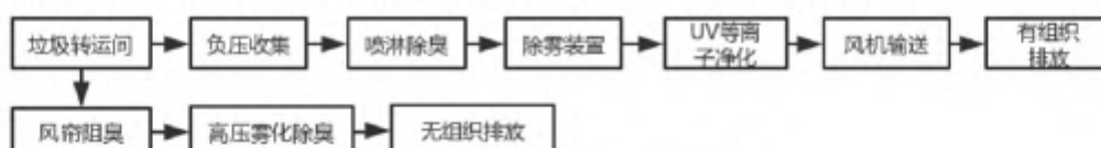
图 8-1 臭气处理工艺流程
