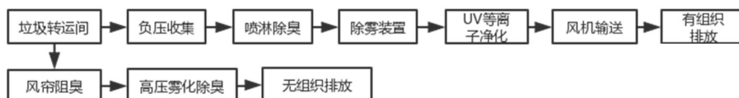
图 8-1 臭气处理工艺流程
