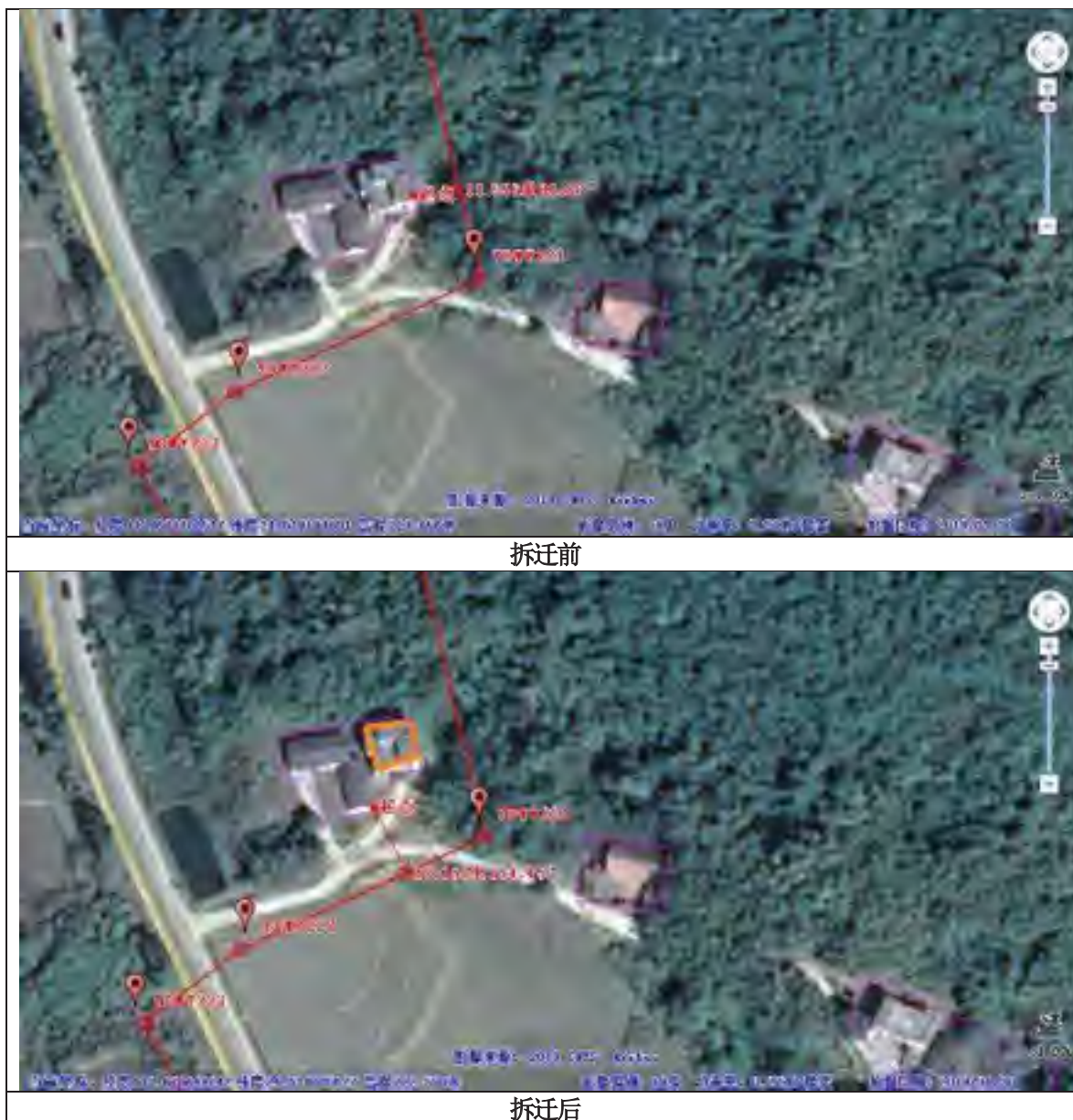
图 2.7-2-1 管线两侧 20m 范围内环境敏感点图——韶关市翁源县铁龙林场铁龙工区坑头村 (拆迁前最近距离 11.6m, 拆迁后最近距离 19.5m)
