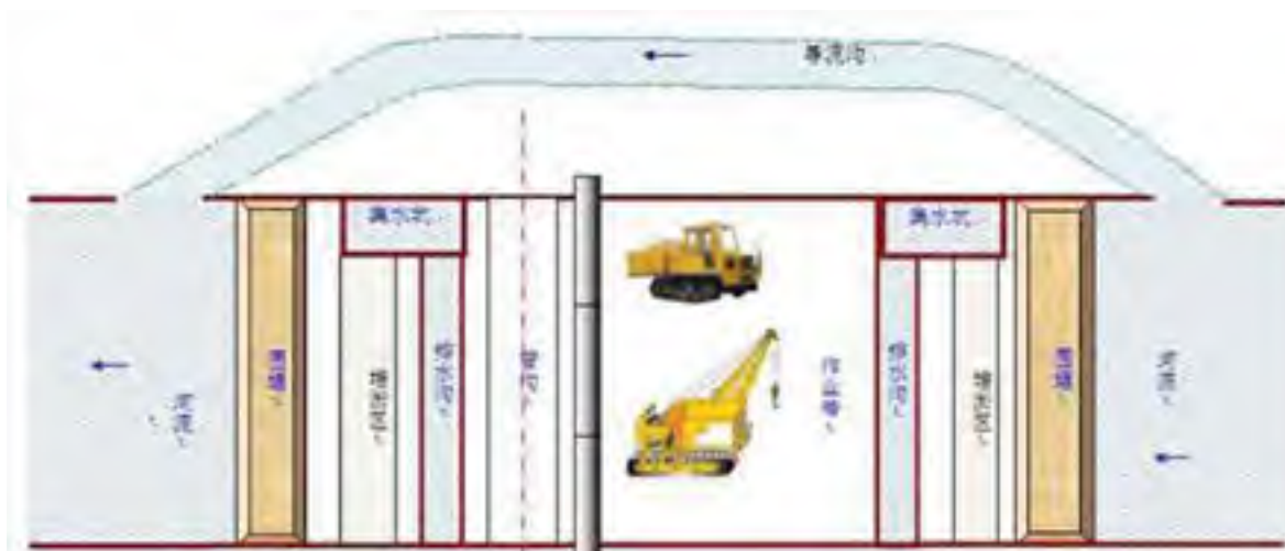
图 4.1-9 围堰导流开挖穿越河流
