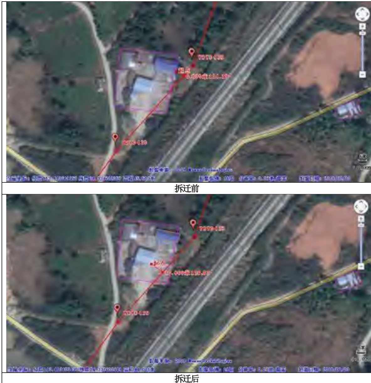
图 2.7-2-7 管线两侧 20m 范围内环境敏感点位置关系图——清远市英德市英红镇星光村张屋 (拆迁前最近距离 6.9m, 拆迁后最近距离 10.5m)
