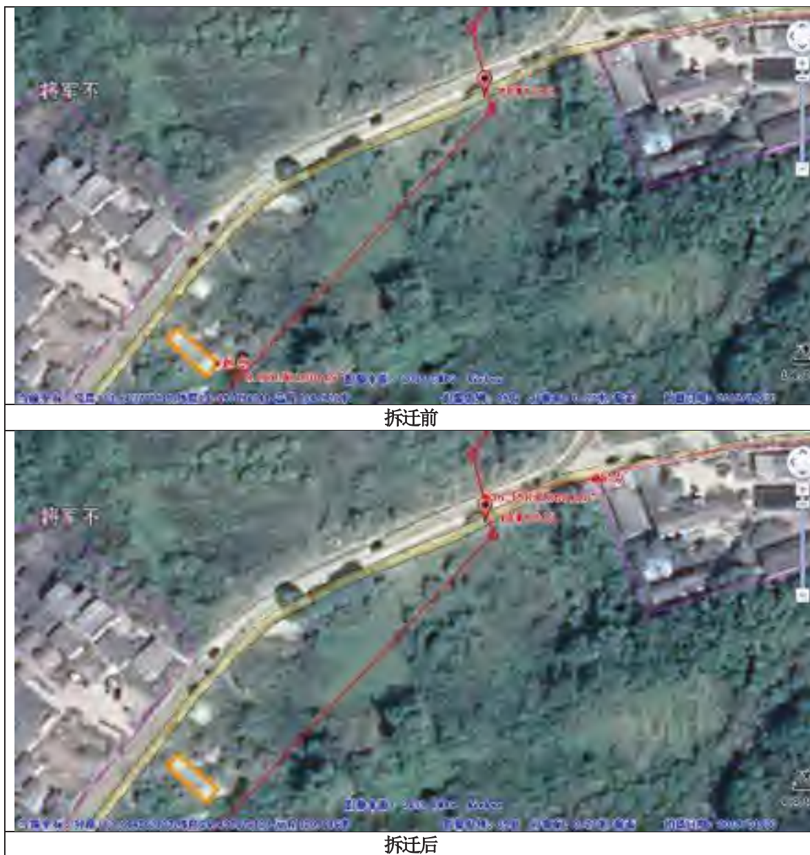
图 2.7-2-2 管线两侧 20m 范围内环境敏感点图——韶关市翁源县铁龙林场铁龙工区将军屯村 (拆迁前最近距离 8.8m, 拆迁后最近距离 36m)
