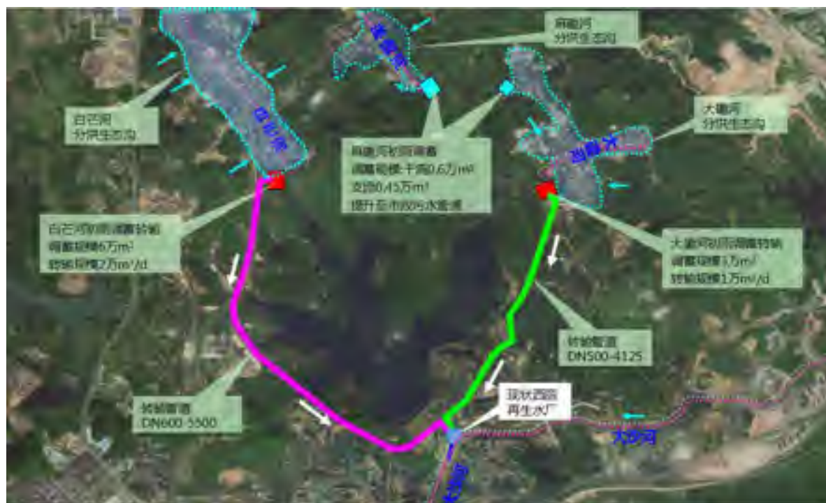
图 2.3-2 西丽三河综合整治工程总平面图
