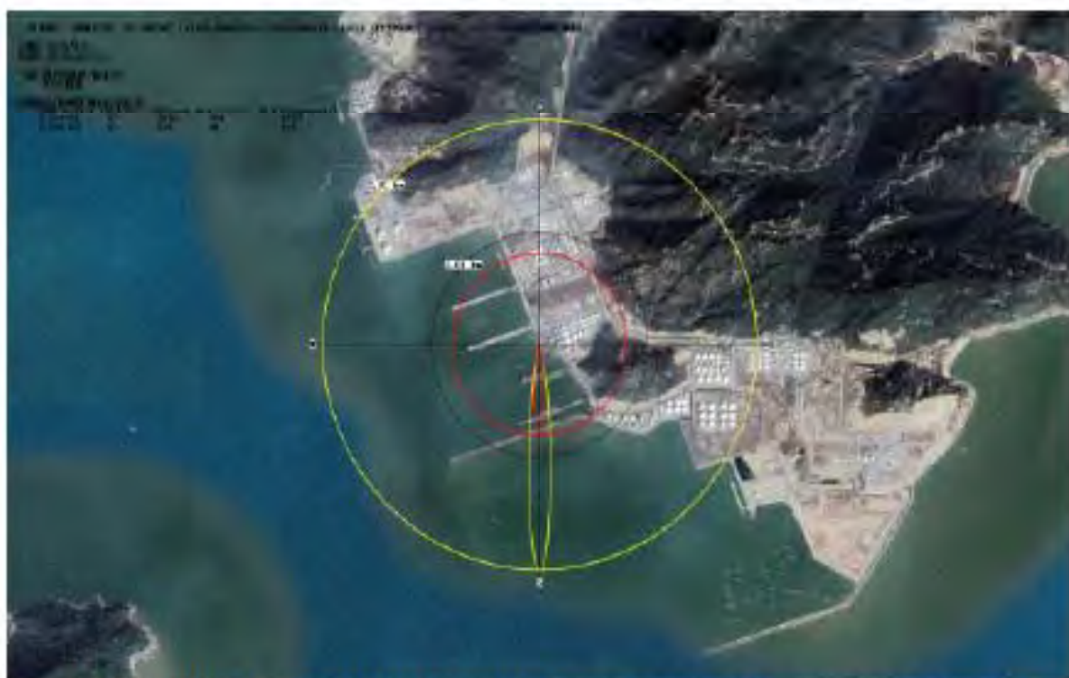
图 9.3-35 DN500 管道全孔径泄漏火灾伴生事故（混合芳烃（以甲苯计））CO 影响范围
