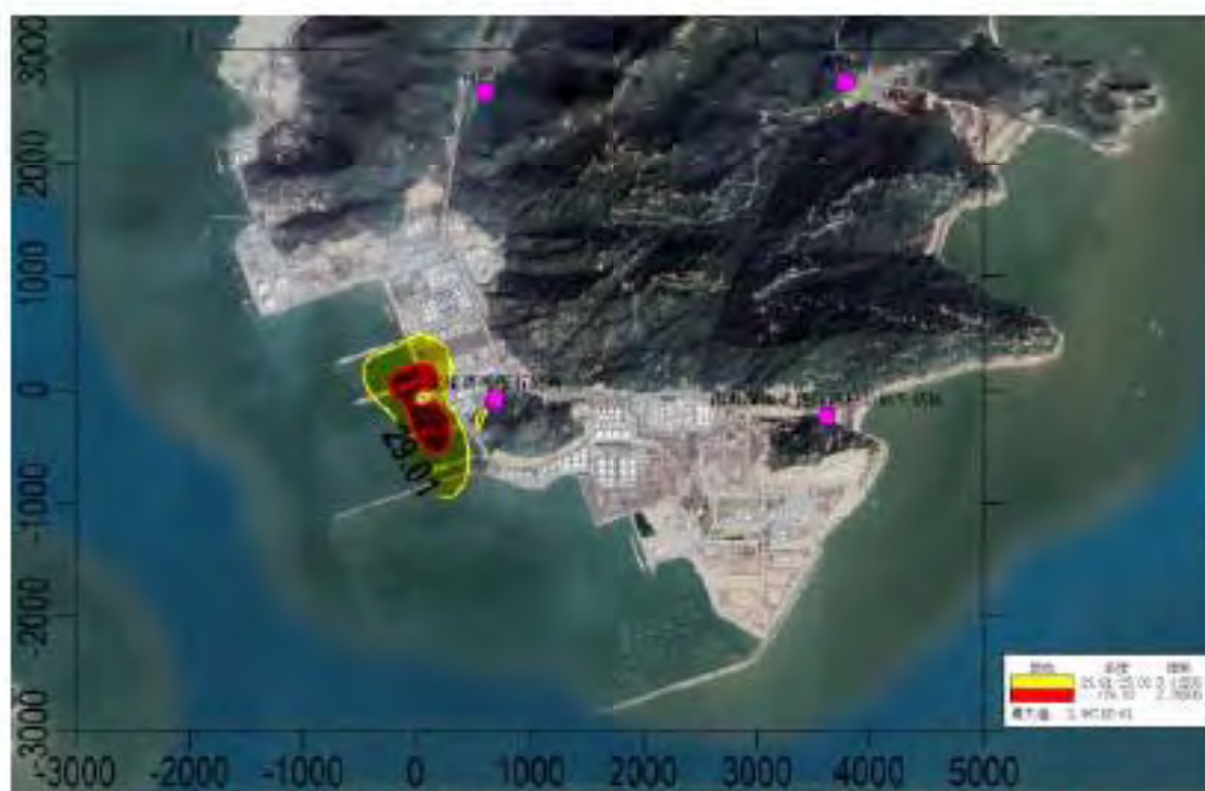
图 8.2-13 2#泊位靠船时 \text{NO}_2 叠加现状浓度后年平均质量浓度分布图( \mu\text{g}/\text{m}^3 )
