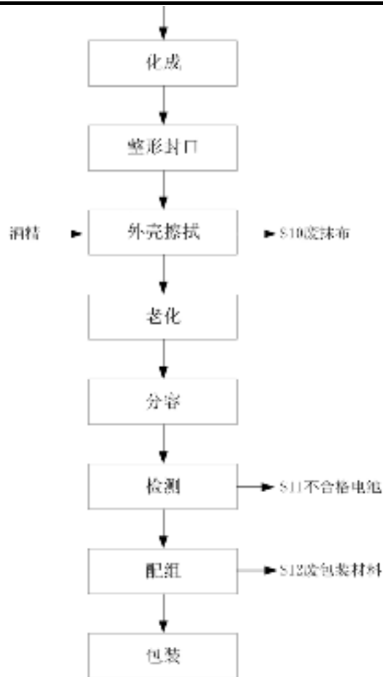
图 1-1 10 亿瓦时动力锂电池新能源建设项目生产工艺流程及产排污环节
