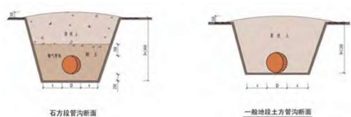
图 3.4-1 不同地段管沟断面示意图
