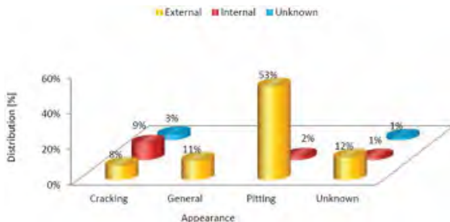
图 7.2-17 1970 年-2013 年不同类型的腐蚀破坏事故统计
