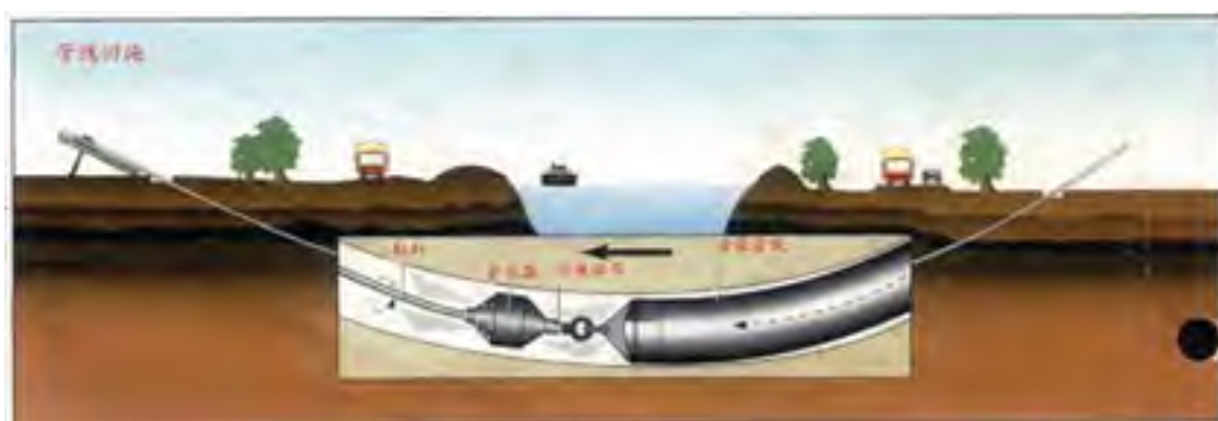
图 4.1-4 管线回拖示意
