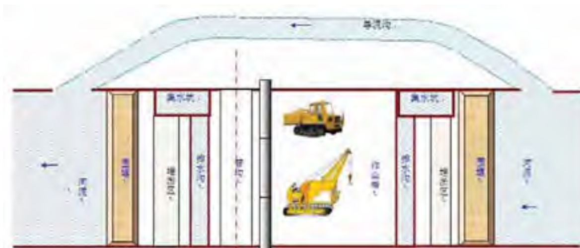
图 4.1-7 围堰导流开挖穿越河流
