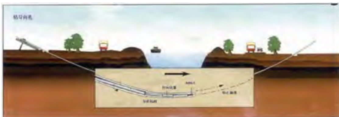
图 4.1-2 钻导向孔示意
